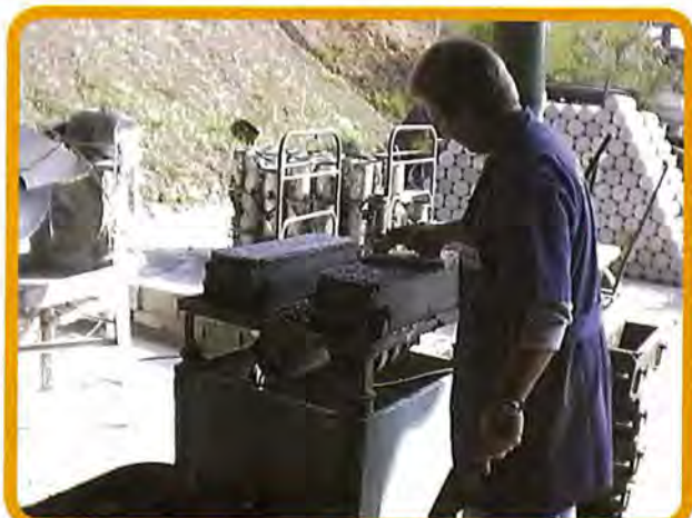
Detalhe para o acabamento da moldagem dos corpos de prova prismáticos de concreto reforçado com fibra.
