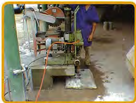
Extração de corpos de prova cilíndricos em placa de concreto projetado
