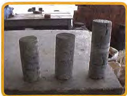
Testemunhos de perfuração em solo e rocha
